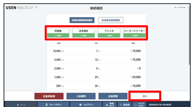
④ 各機器ごとにステータスバーを確認します。機器接続が正常に行われている場合、「接続中」のステータスとなります。自動釣銭機内の在高を確認後、「次へ」をタップします。
