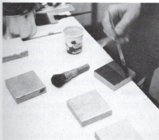
11. Détrempe à l'eau déminéralisée additionnée d'alcool à vernir, en vue de recevoir la feuille d'or.
