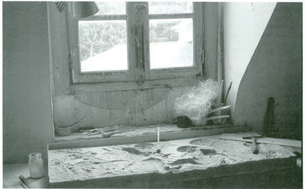
1. Moule à creux perdu passé à la barbotine.
